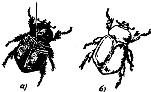
Рис. 145. Подвешивание жука для омеднения (а). Вид жука, покрытого металлом (б)
